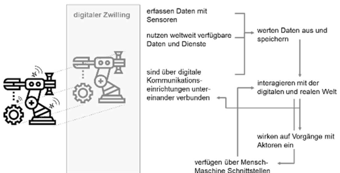
Abb. 3: Abbildung 3: Eigenschaften von cyber-physischen Systemen, eigene Darstellung in Anlehnung an Neugebauer, 2018, S. 190, Icon made by Eucalyp from www.flaticon.com
